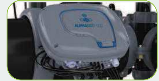
CLD DC Pili Kontrolör Sim Kartlı Geri Yıkama Kontrol Ünitesi Cep telefonuna filtre basıncını ve pulslu su sayacı su miktarını mesajla gönderme özelliği
